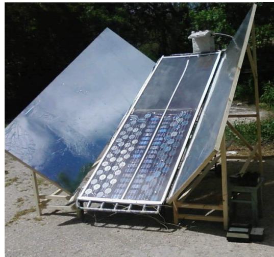
Рис. 2. Комбинированный термофотоэлектрический гелиофиль с концентратором.
