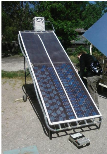
Рис. 1. Комбинированный термофотоэлектрический гелиофиль.
